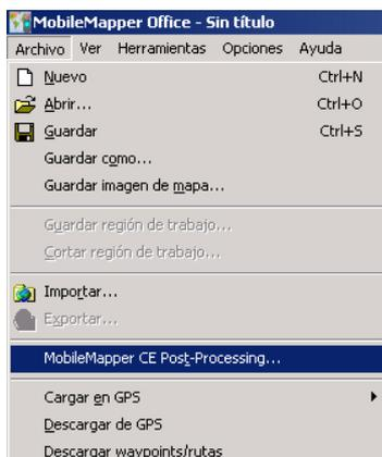
6. Agregue el archivo de forma recogido sobre el terreno mediante ArcPad y la extensión de posprocesado de Thales. Puede utilizar la tecla Mayús para agregar más de un archivo de forma.
