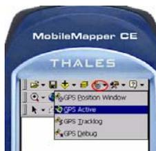
4. Dans la barre d'outils d'ArcPad, taper sur la flèche Bas à droite de l'icône "Marteau/clef" (
